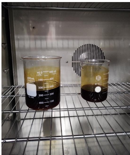
Figura 3.14. Horno de secado, par de muestras con inhibidor.
