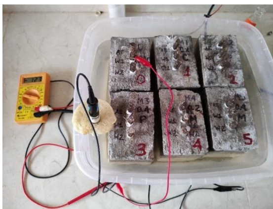
Figura 3.27. Medición del potencial de media cea en el acero de refuerzo.
