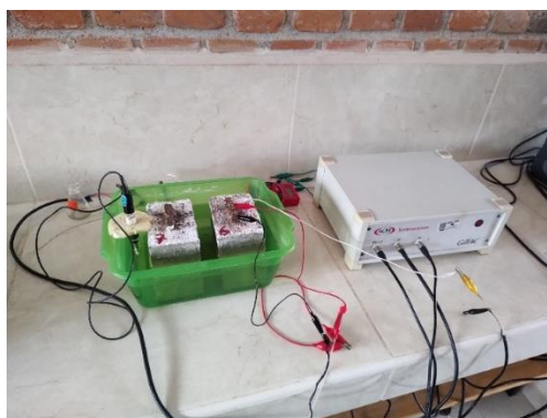
Figura 3.28. Medición del ruido electroquímico en el concreto reforzado.
