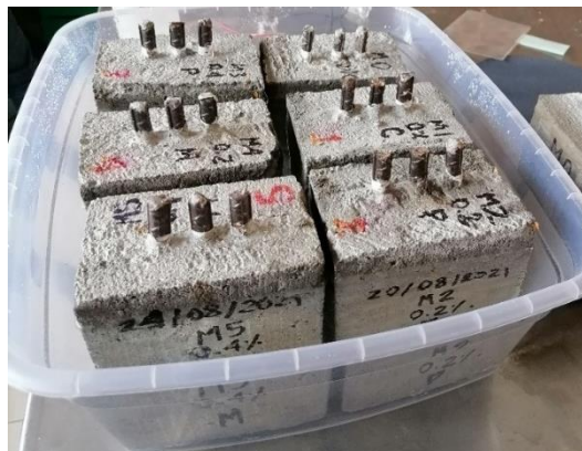
Figura 3.26. Muestras inmersas en ambiente salino 3% de cloruro de sodio.
