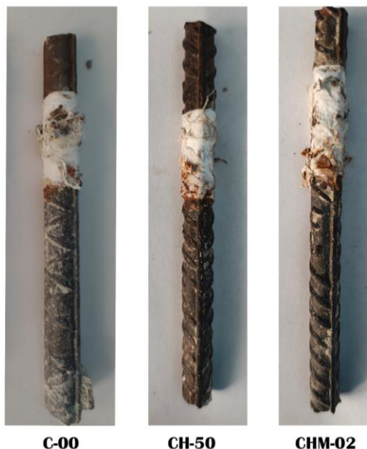
Figura 4.49. Varilla de refuerzo en el concreto después de 365 días de inmersión en medio salino. a) Fibras largas b) Fibras cortas c) Fibras tratadas d) Muestra con inhibidor y fibra.
