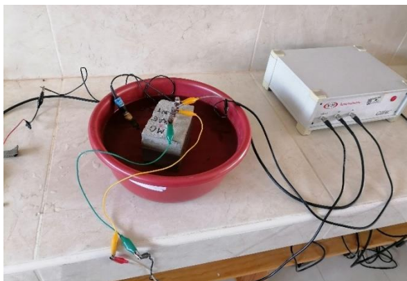
Figura 3.29. Técnica de resistencia a la polarización lineal en la barra de acero.
