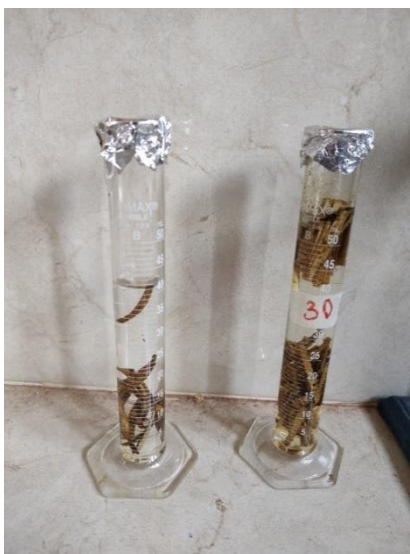
Figura 3.9. Saturación de las fibras tratadas.
