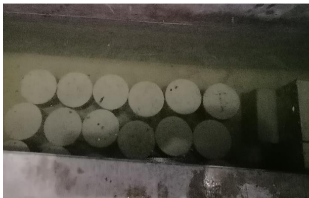
Figura 3.25. Curado de probetas cilíndricas.
