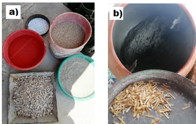
Figura 3.18. a) pesos de los materiales b) incorporación de las fibras naturales de manera aleatoria.
