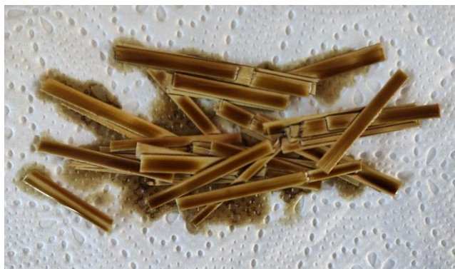
Figura 3.10. Secado superficial de las fibras tratadas.
