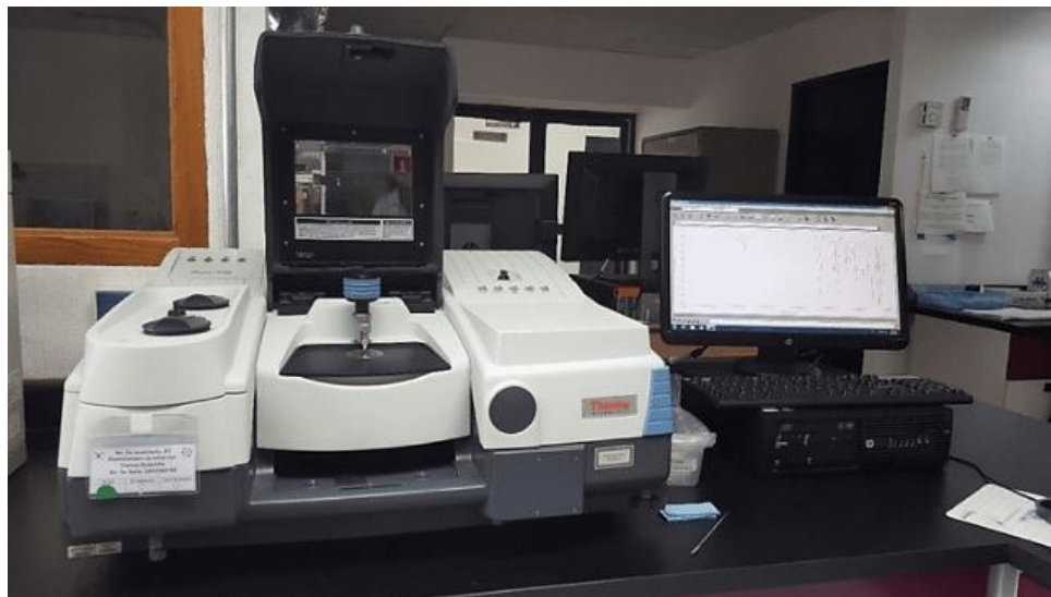
Figura 19. Espectrómetro de infrarrojo por transformada de Fourier (FTIR) Thermo Scientific NICOLET 6700
