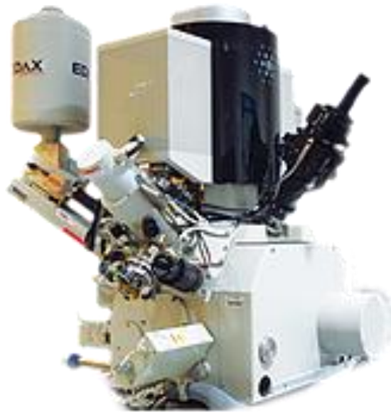
Figura 22. Microscopio de Electrónico de Barrido FEI - FIB Dual Beam Helios Nanolab 600
