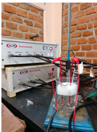
Figura 17. Montaje de celda electroquímica para medición de RE.
