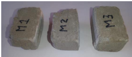
Figura 3.19.- Mezcla a base de Cemento – Arena Silica – Agua para adherencia en adoquines. Fuente: elaboración propia.
