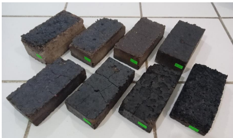
Figura 3.13.- Muestras obtenidas con diferentes composiciones PET-MFCA, T = 280° C. Fuente: elaboración propia.
