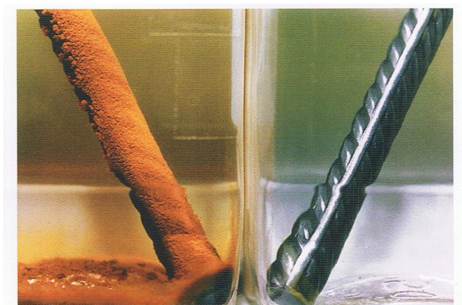
Figura 8. Metal sin y con inhibidor en un ambiente salino
