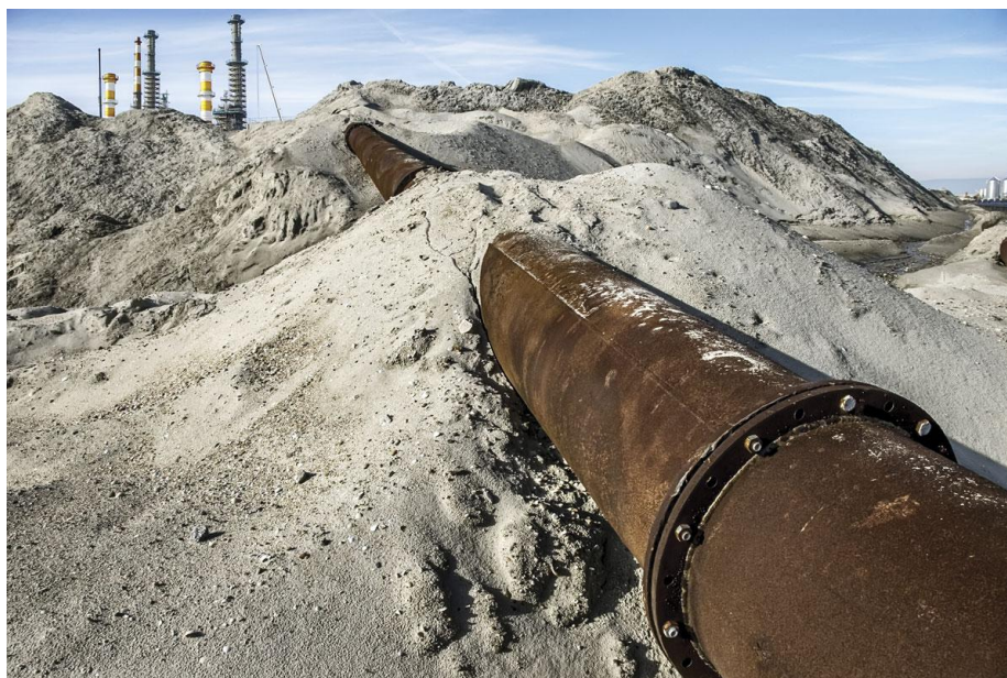
Figura 7. Corrosión en ducto petrolero
