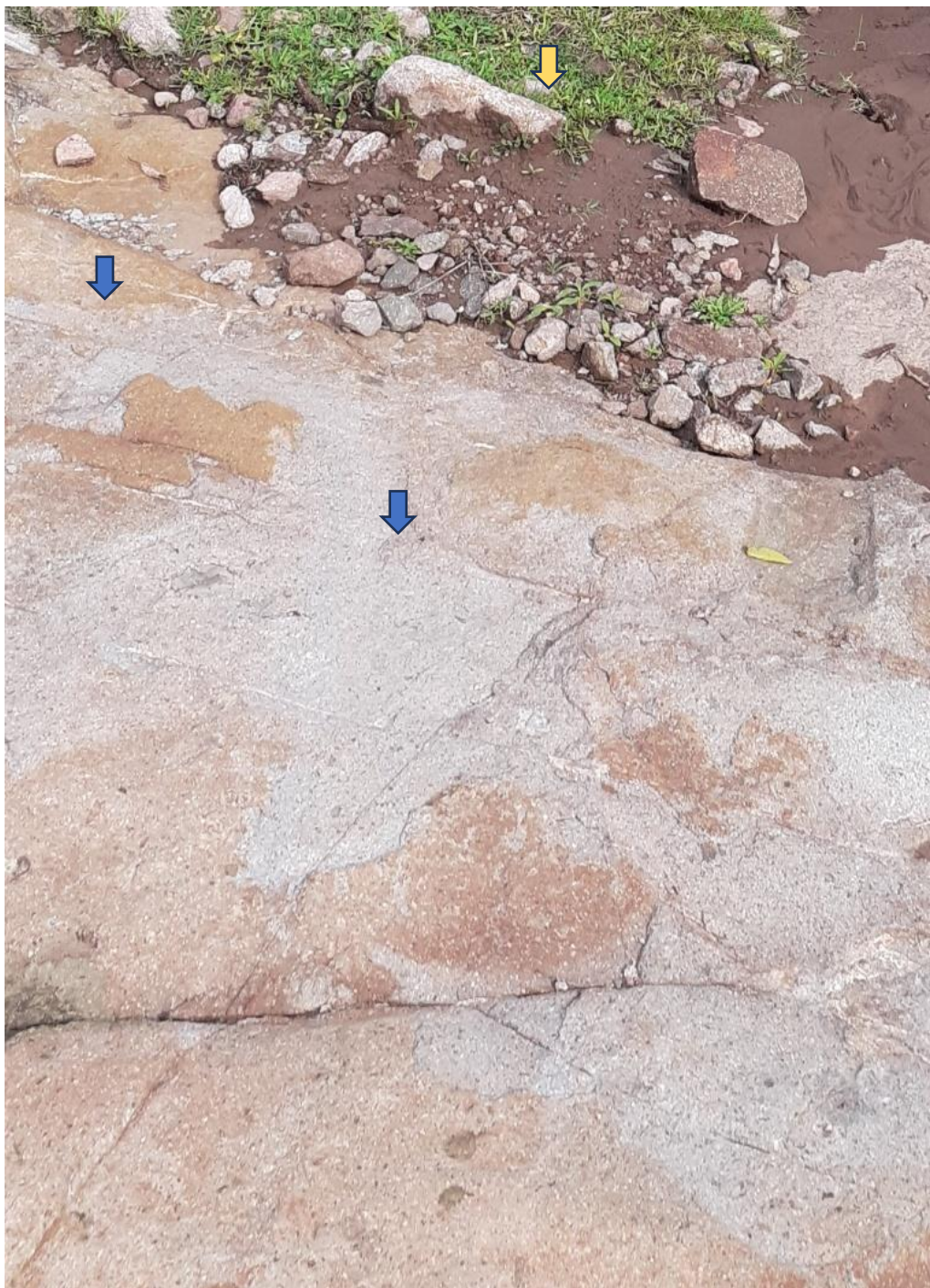
Figura F. Manchado de rocas calizas en el lecho de un arroyo seco por reacción de la caliza con el drenaje ácido de los jales (flechas azules) (obsérvese la coloración semejante a la de los jales) y jales depositados el arroyo (flecha amarilla) (Foto: Márquez-Huitzil, R., 2022).
