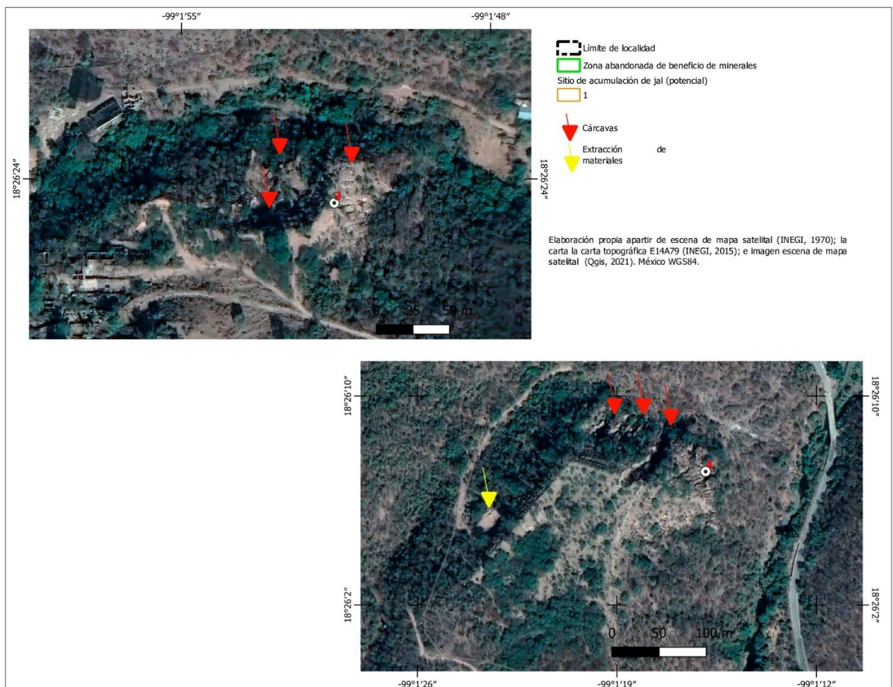
Figura 6. Formación de cárcavas en presas de jales (flechas rojas) y escasa vegetación. a. Los Molinos; b. Las Presas con extracción de jales (flecha amarilla). Fuente: Qgis (2021).
